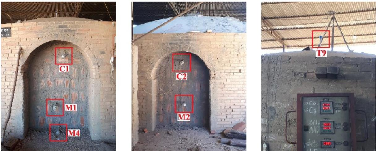
**Figura 8** - Termopares instalados no forno em estudo.
