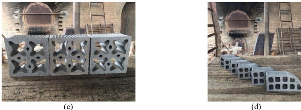
**Figura 49** – Amostras selecionadas para ensaio – (a) maciço, (b) quatro furos, (c) cobogó, (d) tijolo de canto.
