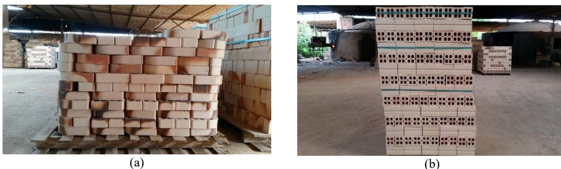
**Figura 9** – Aspecto visual das peças cerâmicas – (a) tijolo de canto, (b) quatro furos.
