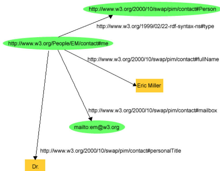
Figura 15. Exemplo realista de um recurso descrito em RDF. Fonte: Manola e Miller (2004).
